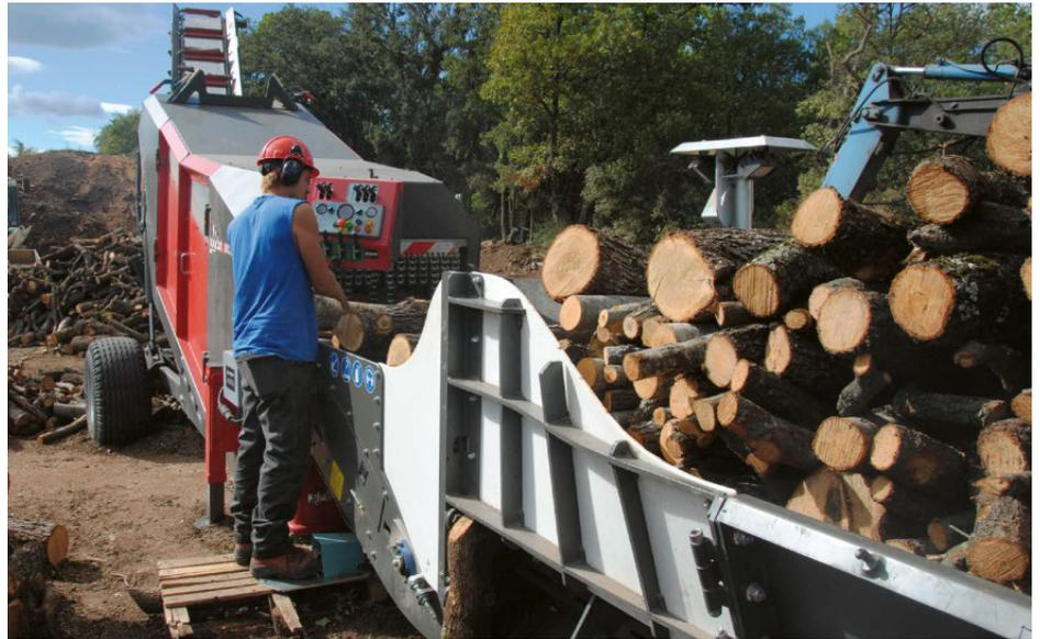
Die Beschickung der Brennholzsäge erfolgt manuell. An die Brennholzsäge lässt sich eine Ladeplattform mit Holzauflage und Sortiervorrichtung montieren. Die Länge der Holzauflage ist modulierbar und kann bei Bedarf von 3,6 m Minimallänge auf 5 m verlängert werden.
