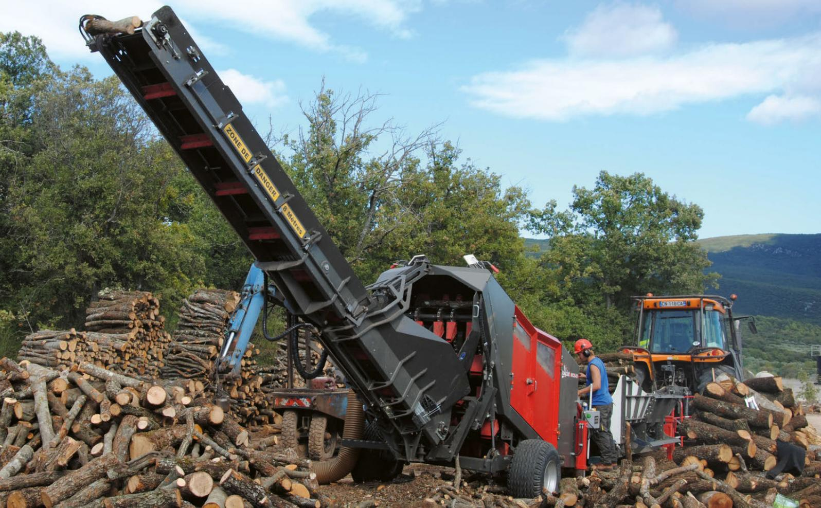
*Der Logcut MCS40 in Caseneuve, nördlich von Aix-en-Provence. Die Brennholzsäge läuft hier mit Zapfwellenantrieb. Sie kann aber auch mit Strom betrieben werden. Für den Antrieb mit Zapfwelle empfiehlt der Hersteller einen 60 PS starken Traktor, den Elektrobetrieb ermöglicht ein Dreiphasenmotor mit 30 kW Leistung. Das Abführband ist horizontal und vertikal schwenkbar.*
