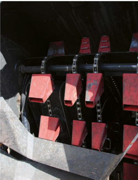
Das mit Klötzen versehene Förderband führt das Holz den Sägen zu. Die Meterholzstücke liegen lose auf den Klötzen auf, was auch bei krummem Holz eine reibungslose Schnittführung ohne Verkeilen oder Verklemmen gewährleistet.
