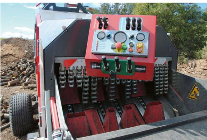
Der Einzug für die manuelle Beschickung mit Meterholz mit der Steuerungs- und Bedieneinheit. Die Bedienung der Maschine ist mit den nötigsten Hebeln und Knöpfen übersichtlich. Der rote Notstopp-Knopf befindet sich in der Mitte der Bedieneinheit. F. Oberer
