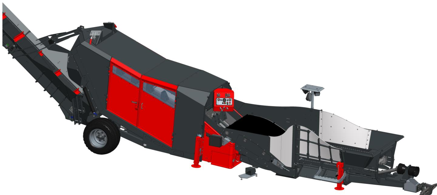
Il Profit Pack concentra le due caratteristiche principali del LOGCUT MCS40: da un lato la capacità di riscolpire grandi volumi di legno e dall'altro la versatilità di una macchina mobile. Questa versione è dotata di una piattaforma di carico a pinza e di un sistema di spandimento automatico del legno. L'ergonomia della postazione di lavoro è stata progettata per ridurre al minimo gli sforzi fisici dell'operatore, massimizzando al contempo le prestazioni della macchina.
